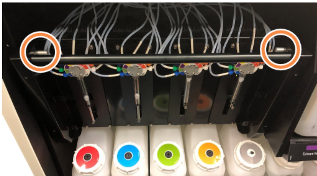
Slika 12–9: Lokacija zatika za otpuštanje s otvorenim uređajem radi pristupa
