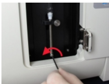
Slika 12–17: Imbus ključem odvrnite vijak za blokiranje klipa
