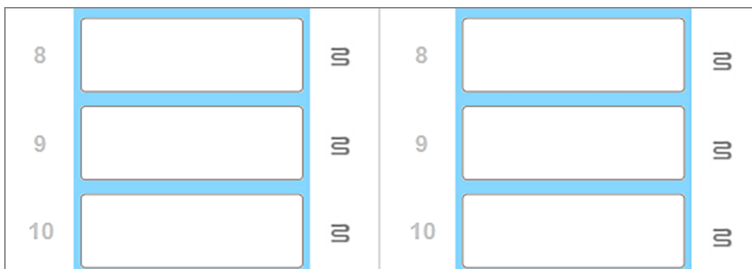
Slika 2–8: Sivi simboli grijača u svakom položaju ukazuju na potpuno isključenje grijanja
