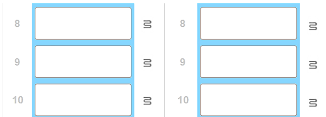
Slika 5-4: Sivi simboli grijača u svakom položaju ukazuju na potpuno isključenje grijanja
