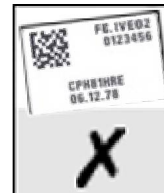
Slika 6–6: Postavite naljepnicu unutar rubova stakalca
