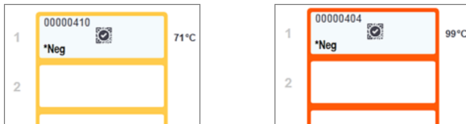
Slika 5–6: Granice s indikatorom temperature na posudicama za stakalca: toplo (lijevo) i vruće (desno)
