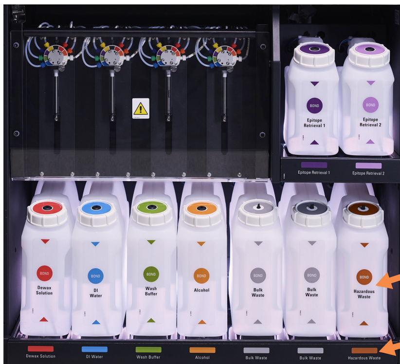
Фигура 2-14: Резервоари за наливни реагенти BOND-III в позиция
