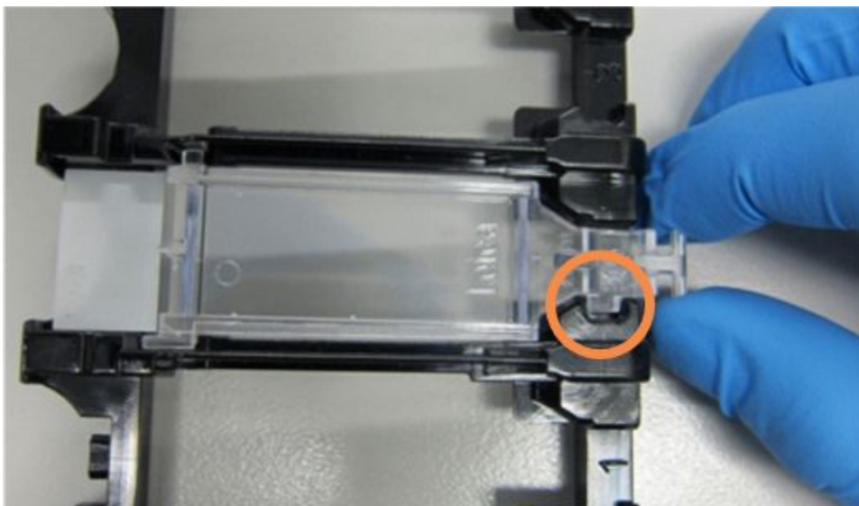
Фигура 4-6: Позициониране на Covertile върху предметно стъкло
