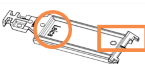
Фигура 2-28: BOND Universal Covertile (нова конструкция)
