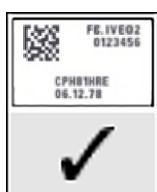
Фигура 6-6: Поставяне на етикета в рамките на ръбовете на предметното стъкло
