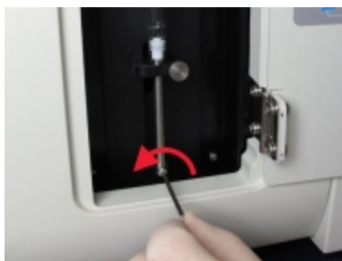
Фигура 12-17: Развиване на винта за заключване на буталото с шестограм
