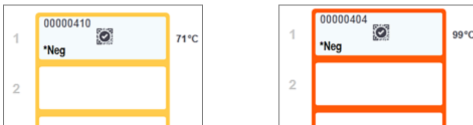
Фигура 5-6: Контури на температурната индикация на таблите за предметни стъкла: топла (ляво) и гореща (дясно)
