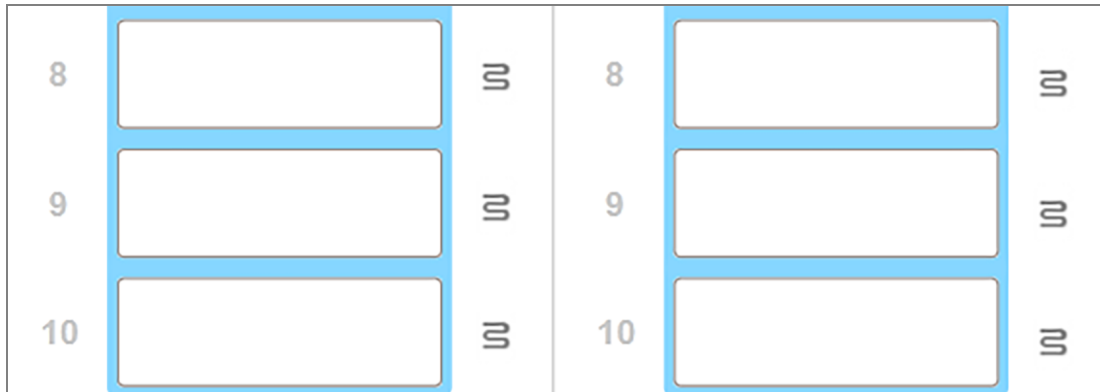
Фигура 5-4: Сивите символи на нагревател на всяка позиция показват пълно изключване на нагревателите
