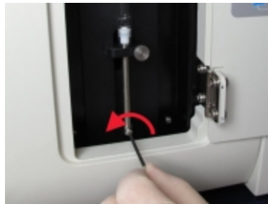
Figură 12-17: Deșurubarea șurubului de blocare a pistonului cu o cheie hexagonală
