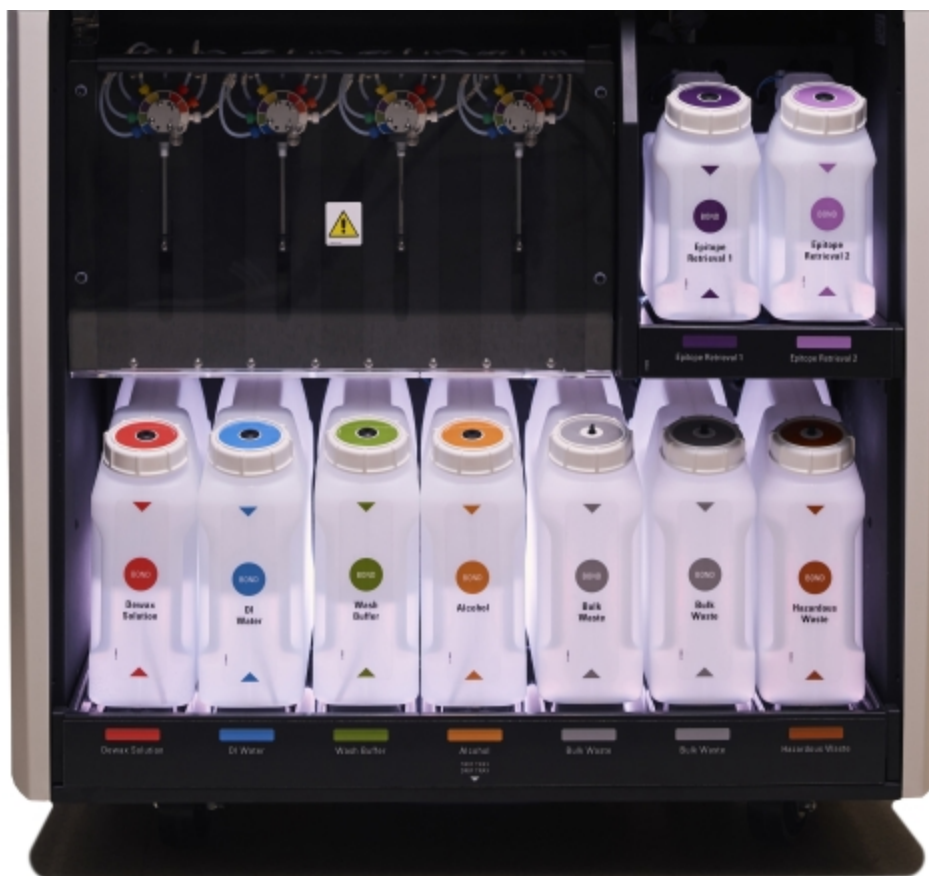
Figură 2-15: Sistem de iluminare pentru recipiente vrac
