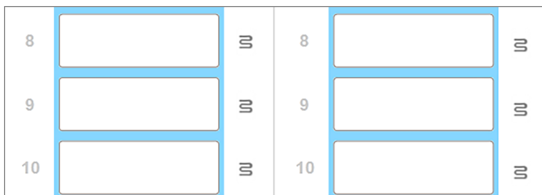
Figură 2-8: Simbolurile de încălzire gri din fiecare poziție indică o închidere completă a încălzirii
