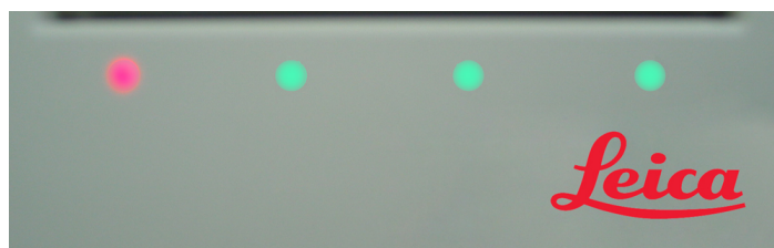
Figură 2-13: Culorile indicatorului LED pentru tava pentru reactivi (roșu, verde) pe instrumentul BOND-MAX
