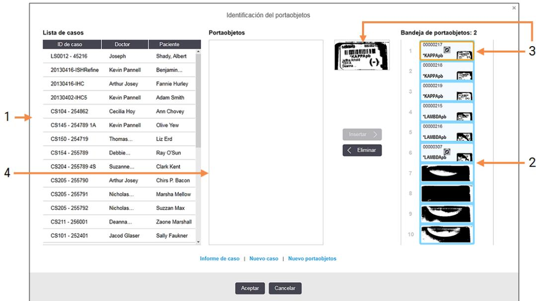
En el panel de la izquierda (elemento 1) se muestran todos los casos con portaobjetos sin procesar. Bajo la configuración predeterminada, solamente aparecen los casos con portaobjetos para los que se haya imprimido etiquetas (puede cambiar esta configuración para que incluya casos con portaobjetos para los que no se haya imprimido etiquetas, consulte [6.8.2.2 Etiquetas de portaobjetos externas](#)).
