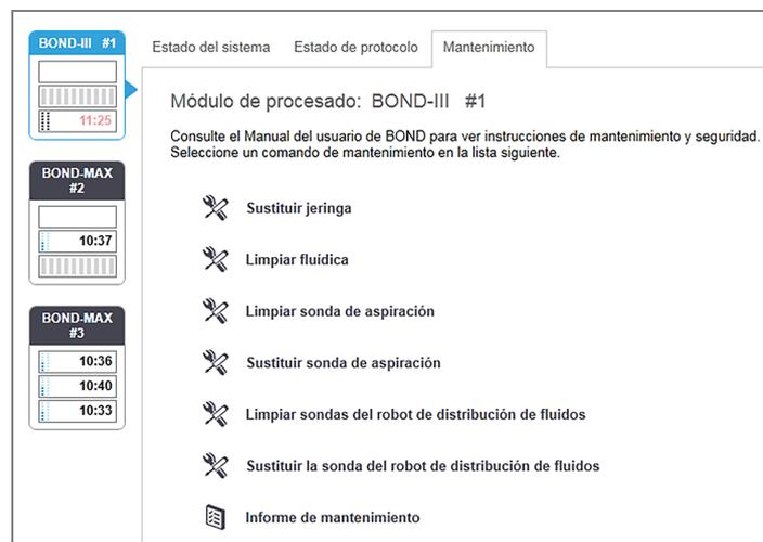
La pantalla **Mantenimiento** tiene botones de comando para diversas tareas de mantenimiento, que se enumeran a continuación:
