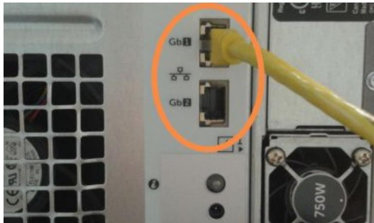
El sistema BOND-ADVANCE detecta que ha conectado los cables de red al controlador secundario y muestra un diálogo de confirmación en todos los terminales.
