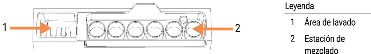
El área de lavado de la izquierda tiene pequeños orificios para lavar la sonda de aspiración.
