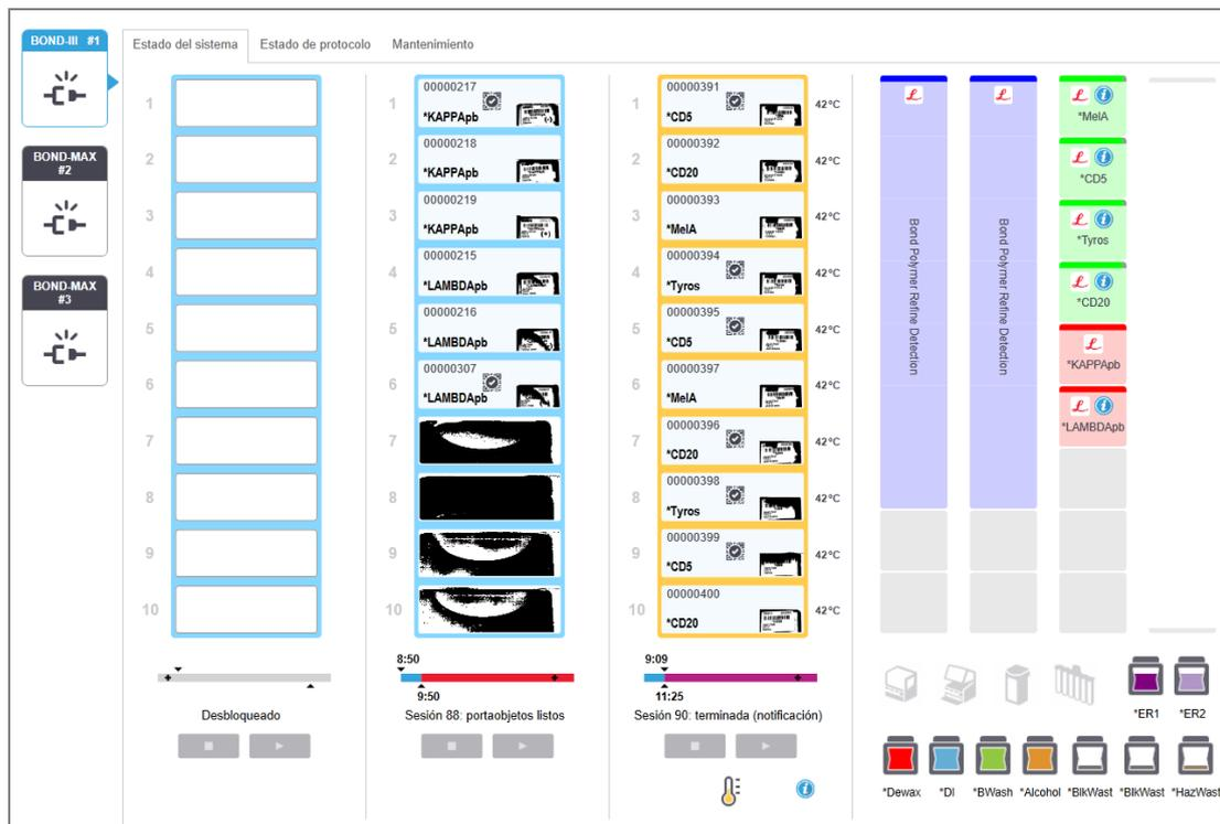
Las fichas de módulo de procesado de la izquierda de las pantallas de estado ofrecen un resumen visual del estado del módulo de procesado asociado. Haga clic en la ficha para ver el estado detallado del módulo de procesado.
