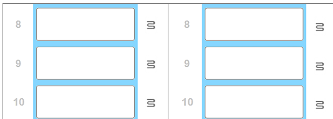
Figura 2-8: Símbolos de aquecedor cinzentos em cada posição indicam paragem completa do aquecimento
