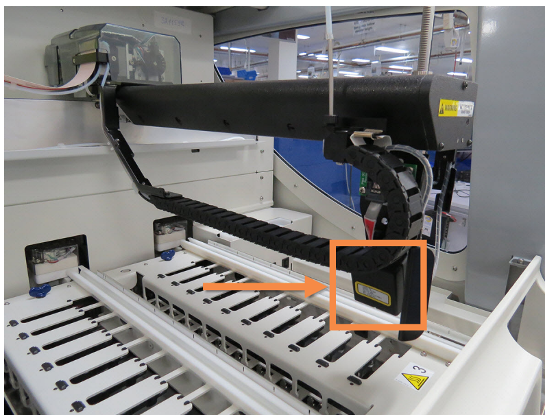
Figura 2-6: Fotografia do robot principal com o leitor de ID indicado pela seta
