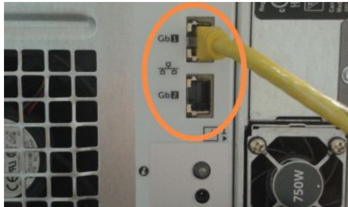
Figura 16-5: Portas Ethernet utilizadas para o LIS
