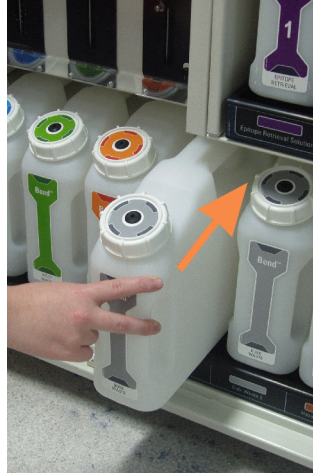
Figur 12-1: Sett avfallsbeholderen tilbake til sin posisjonen
