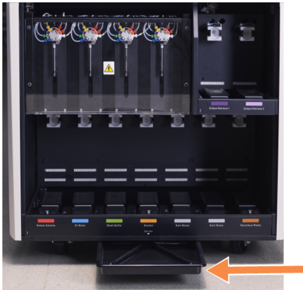
Figur 12-14: BOND-III behandlingsmodulens dryppbrett
