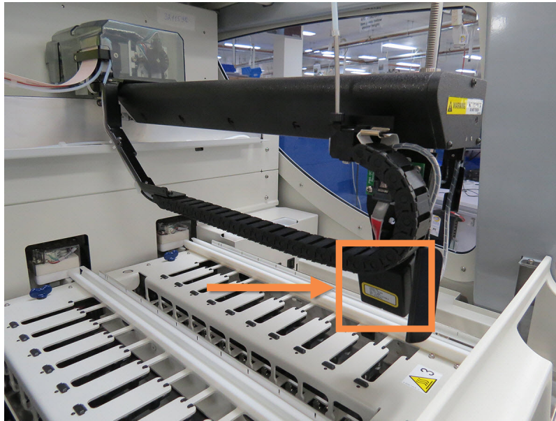
Kuva 2-6: Päärobotti; tunnisteiden kuvantaja osoitettu nuolella
