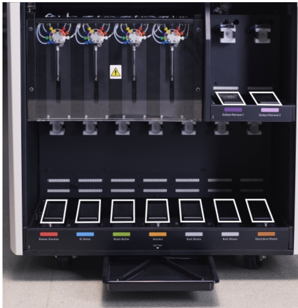
Kuva 12-13: BOND-III-bulkkisäiliön tippatelineet sekä painoanturin suojukset
