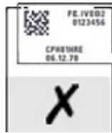
Kuva 6-6: Kiinnitä merkintä leikkeen reunojen sisäpuolelle.
