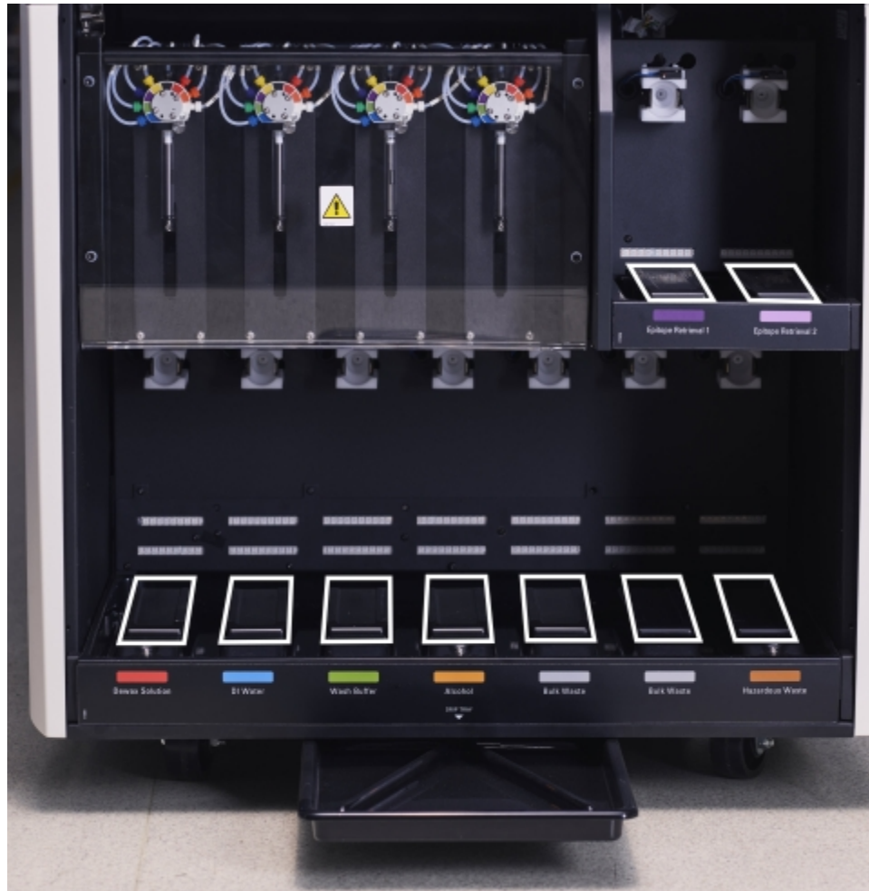
Figur 12-13: BOND-III-bulkbeholdernes drypbakker, der viser vægtsensorkabinetter
