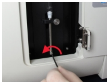
Figur 12-17: Du skal løсне stemplet låseskrue med en umbrakonøgle
