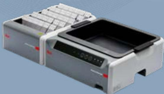
\*La placa para secar los portaobjetos HistoCore está diseñada como un accesorio y no se puede utilizar sin ser conectada al baño.
