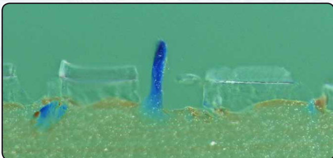
Defecto de recubrimiento transparente
