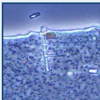
巨大的玻璃纤维穿过面漆 (20 μm)
